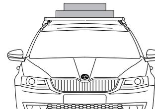
Układanie bagażu - równomierne rozmieszczenie i szerokość bagażu.
