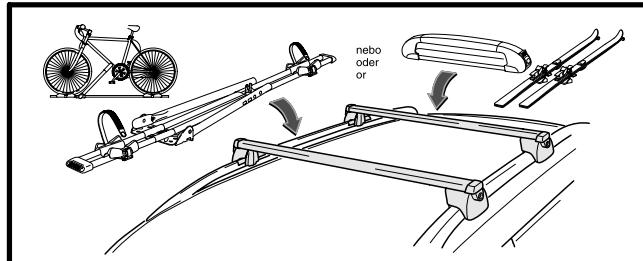
**Upozornění.** Doporučujeme používat pouze držáky montované do T-drážky (T-šroubem). Montáž kovovou objímou tvaru „U“ může poškodit povrchovou ochranu nosných profilů příčníku.
