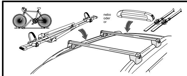
**Advertencia.** Recomendamos usar solamente soportes instalados en la ranura en T (con un tornillo T). El uso de un casquillo en U puede dañar la protección superficial de los perfiles de soporte de la barra transversal.
