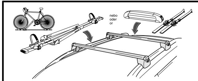
**Hinweis.** Wir empfehlen, lediglich in einer T-Nut (mittels T-Schraube) montierte Halter zu verwenden. Die Montage mittels U-förmiger Metallhalterung kann den Oberflächenschutz der Querträgerprofile beschädigen.
